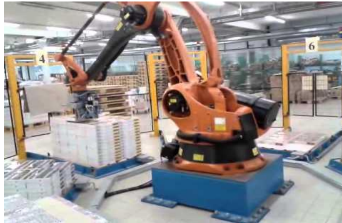
Fig.20 Immagine di robot ANTROPOMORFO
