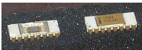
Fig. 12 A sinistra il microprocessore Intel 4004 con la copertura rimossa e a destra come veniva venduto
